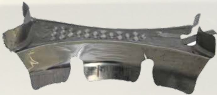
Hitzeschild mit Falten und Risse bestätigt das Simulationsergebnis
