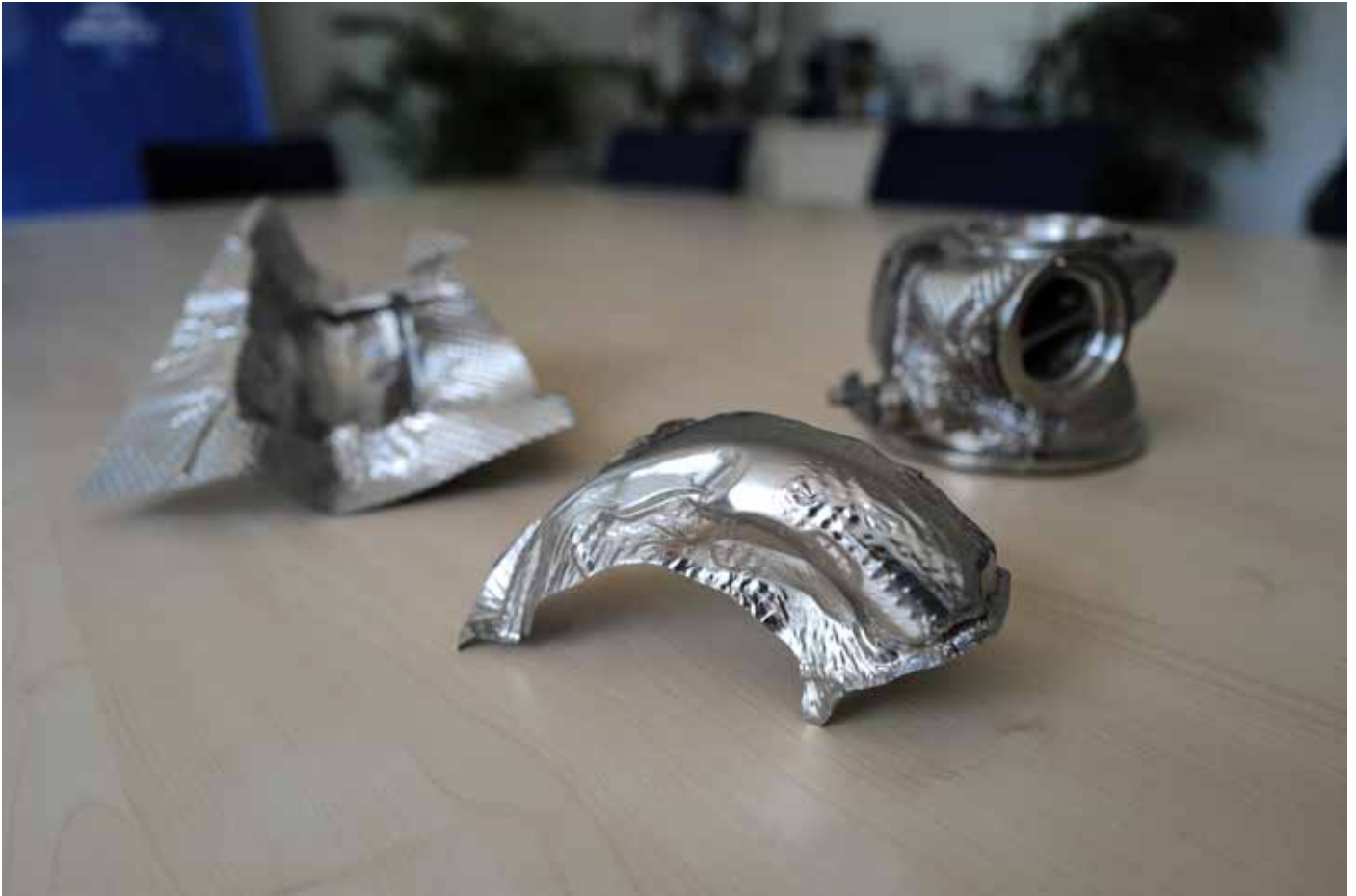
Halbschale für thermische Isolierungen von Turboladern.
