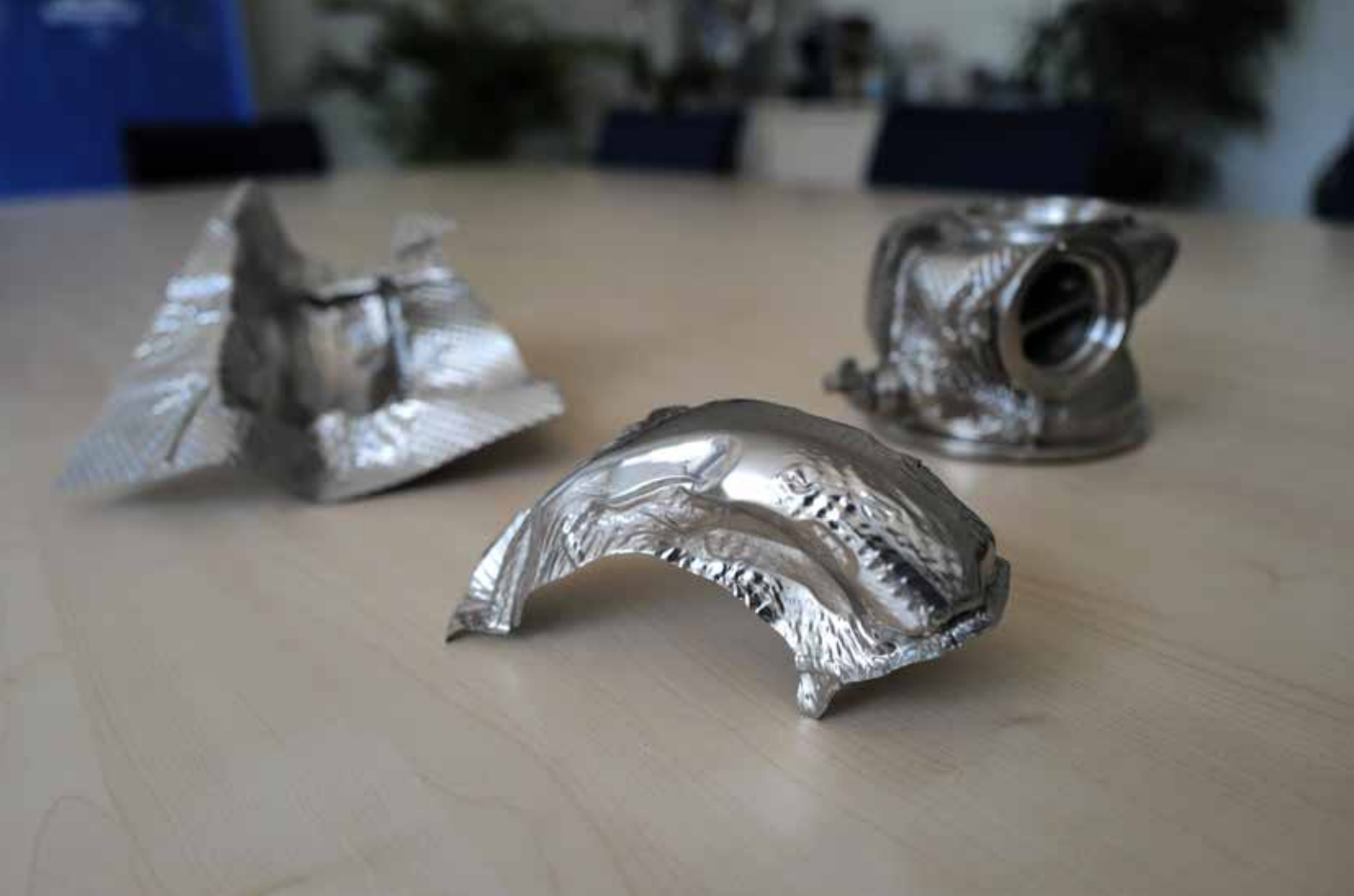
Halbschale für thermische Isolierungen von Turboladern. (Alle Bilder: © Kölle GmbH/ Stampack GmbH)
