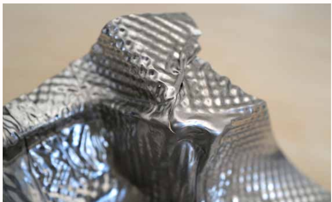
Durch ungünstigen Faltenverlauf gerissene Schale.
